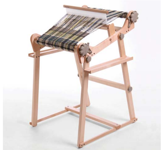
Gatterkammhalterung für das Weben mit zwei Kämmen.
