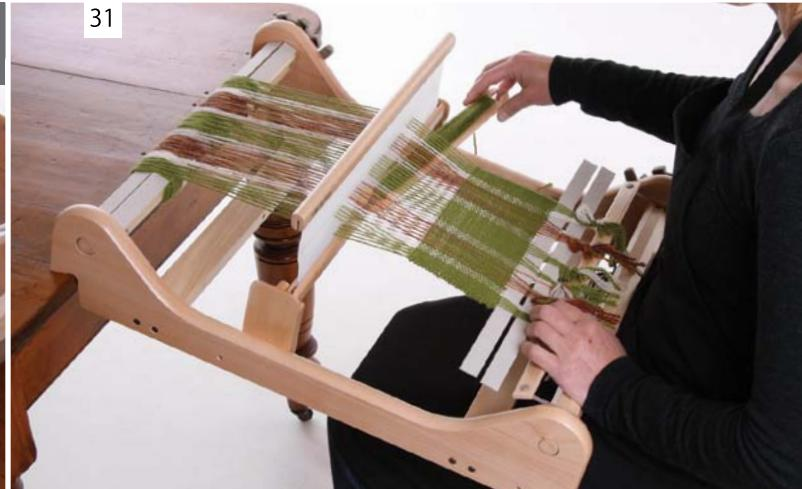
テーブルからはたを取り外し、ひざの上にのせて座ります。はたの底面の切れ込みをテーブルの縁にかけて固定したら、これまでの作業を繰り返します。
