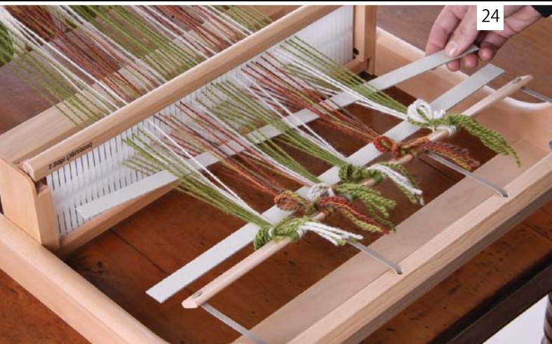
おさを持ち上げて「上げ位置」に置きます。そして開いたたて糸の間に厚紙を通して、まっすぐ手前に引き寄せます。そのままおさを「下げ位置」に移したら、再び厚紙を通して手前に引き寄せて下さい。
