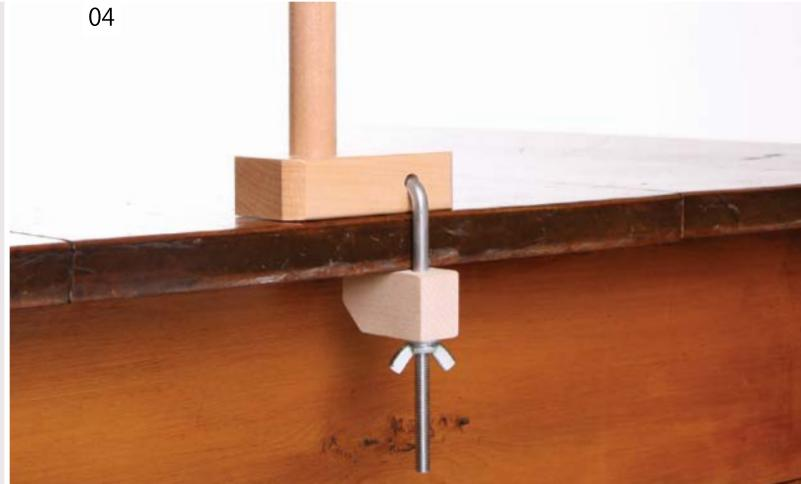
テーブルの反対側にワーピングペグをしっかりと固定します。（テーブルが薄すぎてクランプのねじ山が足りない場合は、クランプを穴に差し込まずに、ペグの土台全体を上から挟むように留めて下さい）
