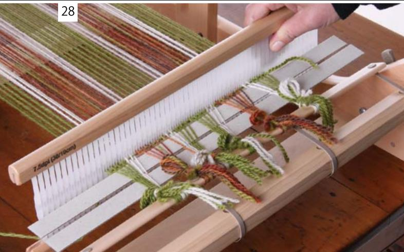
おさをゆっくりと手前に引きよせて、最初の段を打ち込みます。
