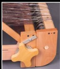
дополнительный навой обеспечивает идеальное натяжение нитей при работе с различными нитями для станков шириной 40, 60, 80 см (16, 24, 32 дюймов)
