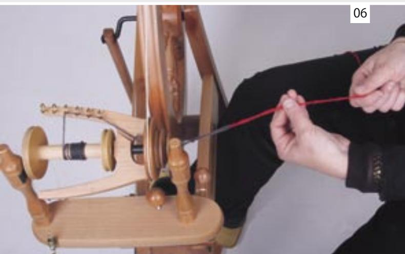
手と足の練習：左手で練習用の毛糸の輪の辺りを持って、はずみ車が時計回りになるようにペダルを踏みはじめます。そして、左手で吸込み口に糸を送り込みます。
