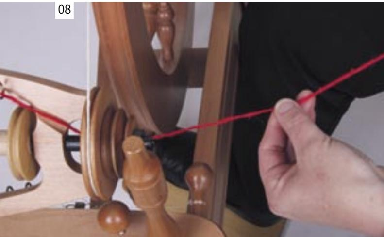
糸を引く練習：1. 左手で糸を持ちます。2. 指の力を少し弱めて、糸に添って手前へ滑らせると、撚りが指を伝ってきます。3. 糸全体に撚りが入ってしまう場合は、再び持つ力を強めます。4. 吸込み口に糸を送り、ポビンに巻き取らせます。
