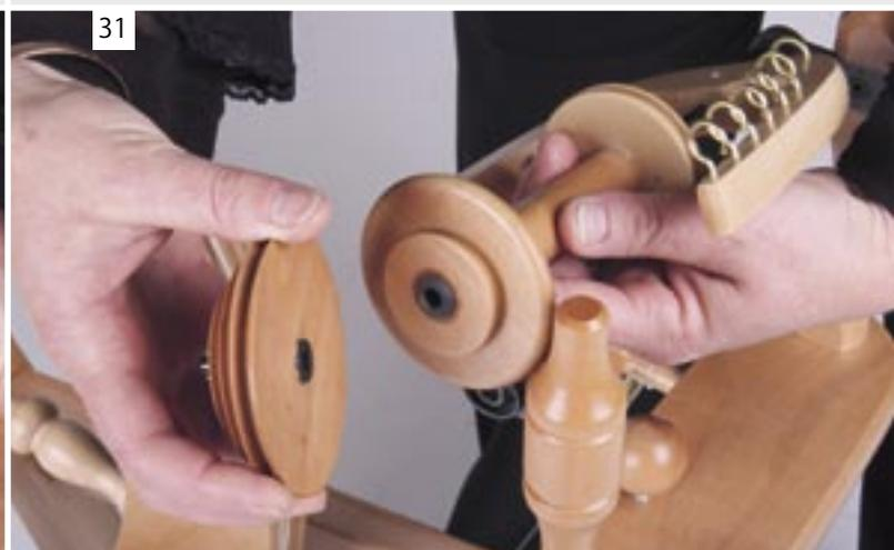
空のボビンを差し込んで、フライヤープーリーを押し込みます。ドライブバンドをボビンとフライヤープーリーにかけ直して、フライヤープーリーの軸を軸受けにしっかりと戻したら、ドライブバンドの張りを確かめます。
