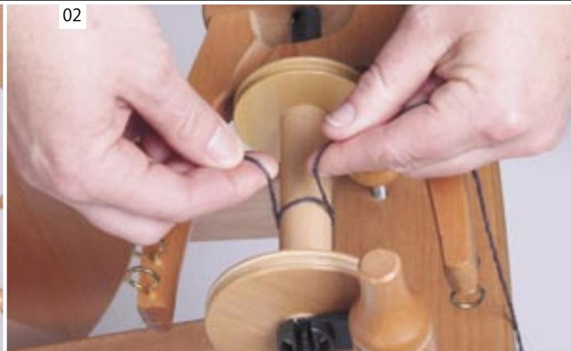
みちびき糸を結ぶ：用意した1.5m程の中細毛糸を、みちびき糸としてポビンにしっかりと結びます。
