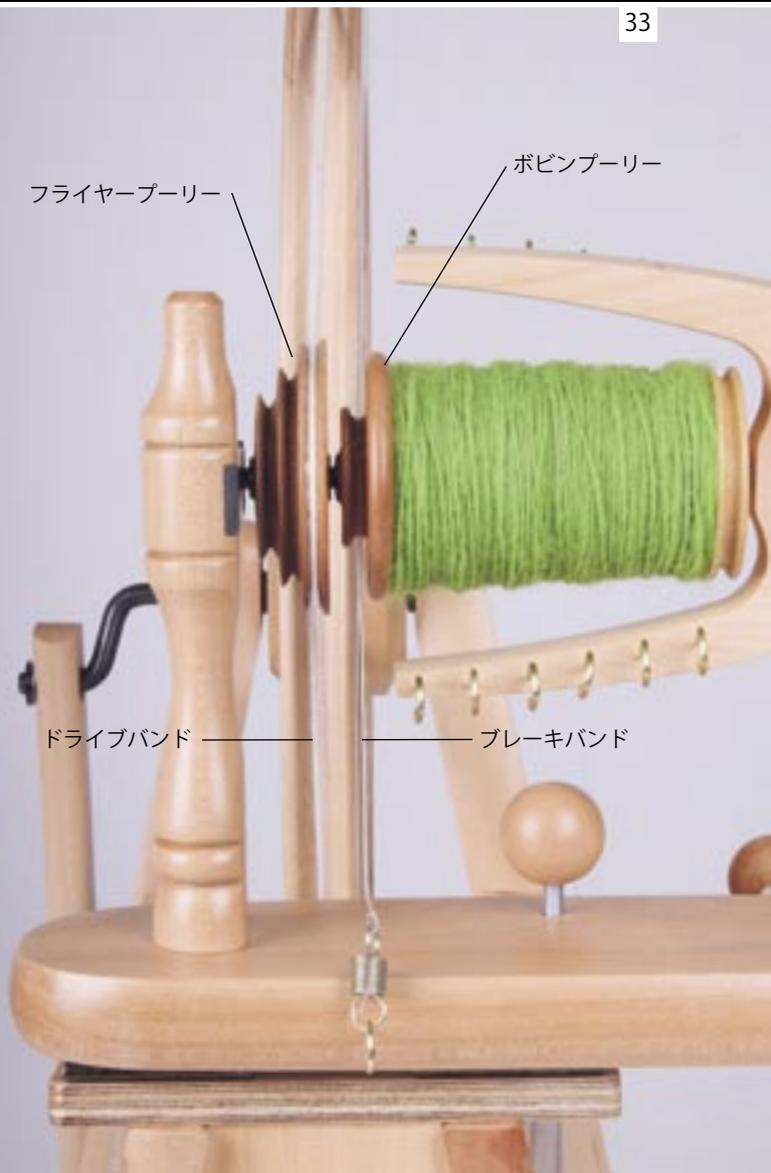
ダブルドライブをシングルドライブとして使うには：ダブルドライブの紡ぎ車は、2本のドライブバンドを両方ともフライヤープーリーにかけて、ポビンプーリーにブレーキバンドをかけると、シングルドライブとして使えます。シングルドライブの要領で、ドライブバンドとブレーキバンドの張りを調節して下さい。（ダブルドライブ時にはブレーキバンドは使いません）
