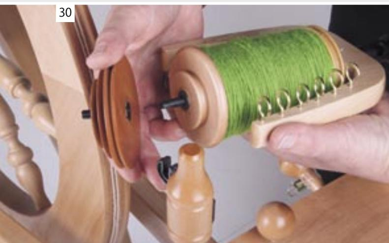
フライヤープーリーを引っ張り、フライヤー軸から外して、ボビンを引き抜きます。
