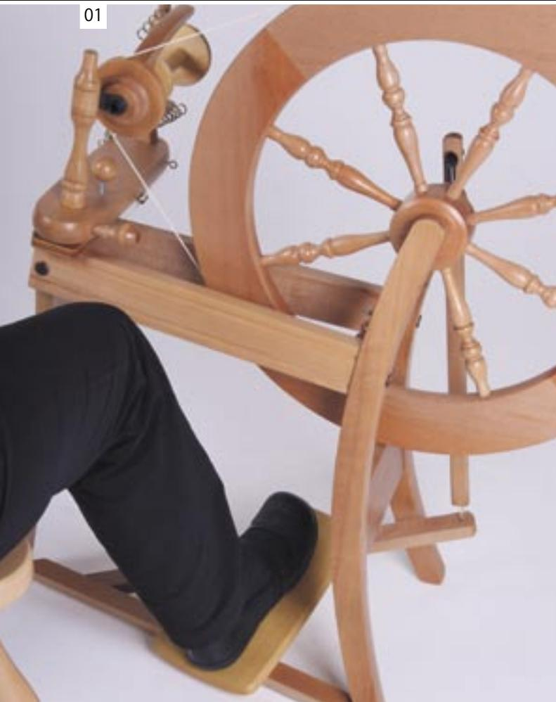
ペダルを踏む練習：紡ぎ車の前に座って、ペダルに足をのせます。はずみ車を手で時計回りに回し、次いでペダルを踏みはじめます。かかととつま先の力を使って踏んで、回したり止めたりを慣れるまで続けます。
