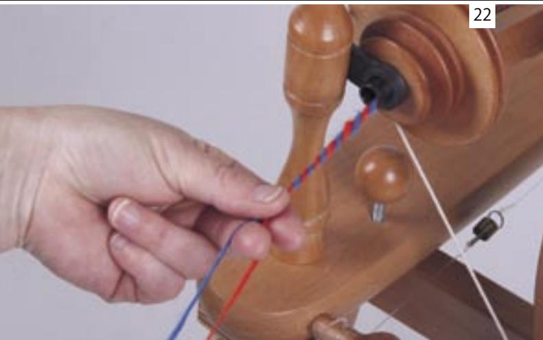
今度は、反時計回りになるようにペダルを踏みます。左手で糸を持ち、撚りがかかる手前に指を挟んで2本の糸を分けます。持つ力を弱めながら、手を手前に滑らせて撚り合わせ、再び持つ力を強め、吸込み口に送りボビンに巻き取ります。
