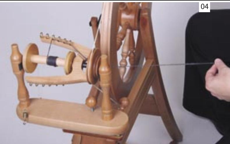
左手でみちびき糸を持ち、はずみ車を時計回りに3回くらい回して、吸込み口からみちびき糸がだいたい50cm出ているところまで巻いたら、はずみ車を止めます。これが糸をポビンに巻き取る始まりとなります。
