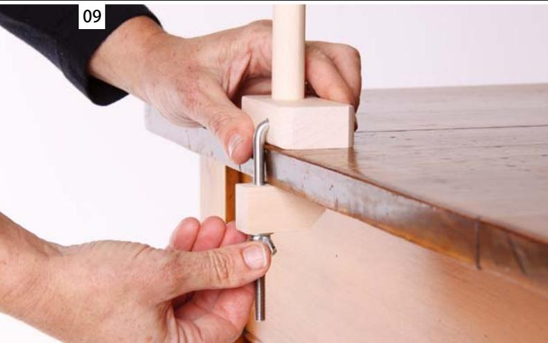
ワーピングペグを土台に差し込んだら、それをもう一方のテーブルにクランプで固定します。
