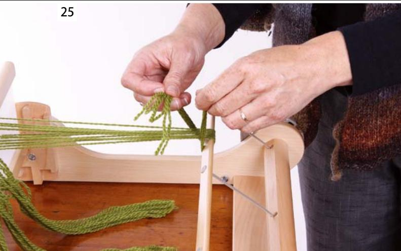
織り機の前に出ているたて糸を、12本ずつの束に分けて、真中の束から順にワープスティックに結んでいきます。束はワープスティックの上から下へくぐらせたところで、束を2つに分けて、その両側を通して上に出して結びます。(写真参照)
