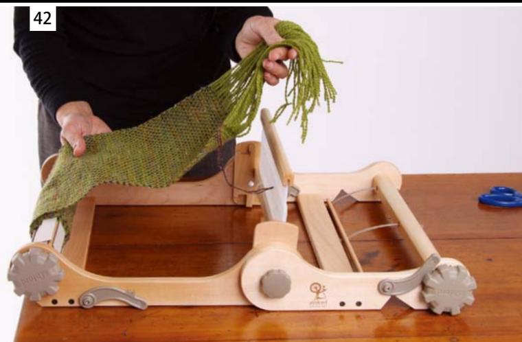
前ブレーキを完全に外して、作品をローラーから外します。
