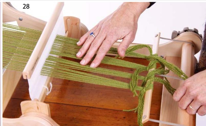
たて糸の張り具合に強弱のむらがある場合は、ワープスティックの結び目で調節して、全ての糸の張りを均等にします。
