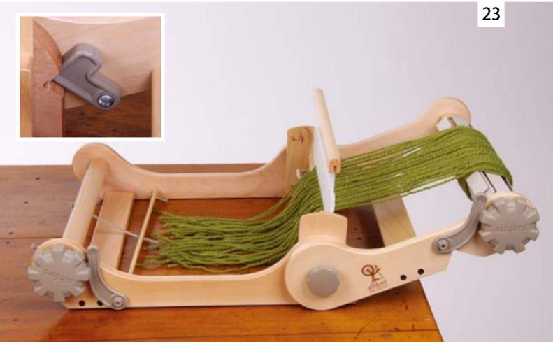
織り機をテーブルから外します。サイドノブを緩めて、本体内側の2つのL字ブロック（左上図）が凹みにかかるまで織り機の後部部分を持ち上げて下さい。おさ立てが上を向いているかどうか確かめて、サイドノブを締めます。
