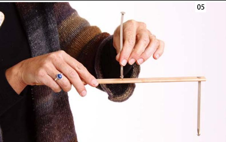
ワープスティックを、前後それぞれのローラーに取り付けます。まず、ワープスティック留めの矢印型になっている方を、ワープスティックの穴に通して下さい。
