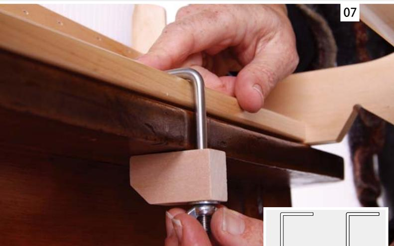
織り機をクランプでテーブルに固定します。右図の様にクランプを組立てたら、織り機の後ろとテーブルを挟んで、しっかりと固定して下さい。
