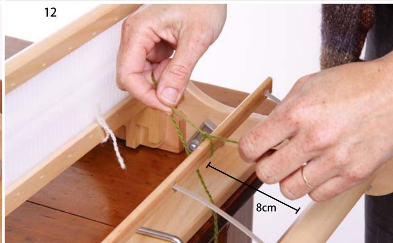
このスカーフのたて糸は 48 本ですので、初めに 24 のすき間に 2 本ずつ糸を通していきます。まず、たて糸の最初の端を目印の糸のすぐ後ろでワープスティックに結んで下さい。この時、ローラーとワープスティックの間隔は約 8cm になっています。
